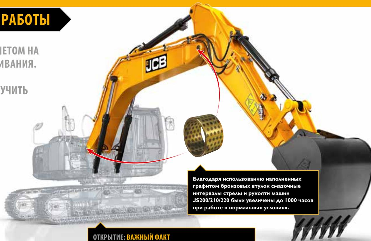
Благодаря использованию наполненных графитом бронзовых втулок смазочные интервалы стрелы и рукояти машин JS200/210/220 были увеличены до 1000 часов при работе в нормальных условиях.
