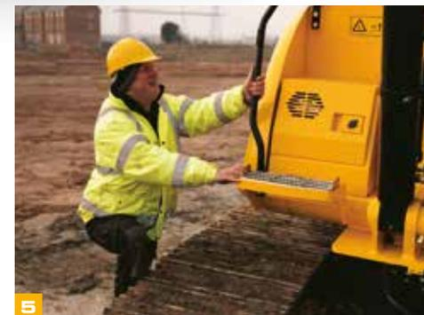
**6** На машины JCB JS200/210/220 можно установить полный комплект зеркал — боковых и заднего вида — для обеспечения круговой обзорности и соответствия требованиям безопасности.
