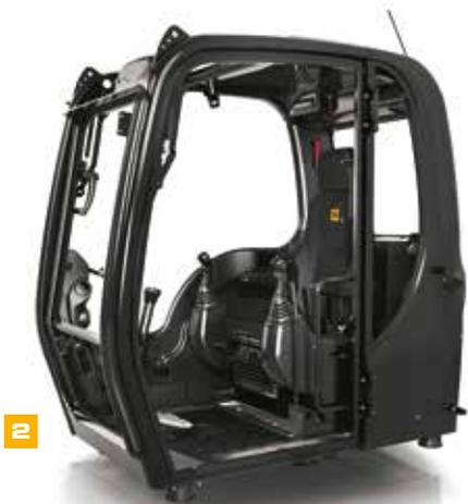
**2** Для полной гарантии безопасности кабины машин JCB JS200/210/220 можно оснастить встроенной защитой от опрокидывания (ROPS). Благодаря наличию стандартных крепежных кронштейнов на экскаваторы также можно установить защиту от падающих предметов (FOPS).
