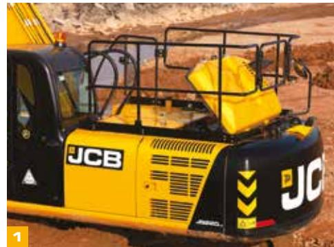
1 Капот экскаваторов JS200/210/220 открывается спереди назад, что обеспечивает удобный и безопасный доступ для обслуживания двигателя.
