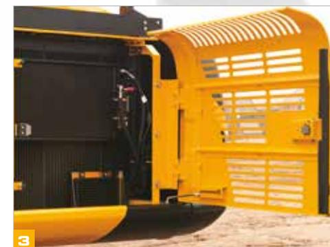
Капот машин JCB JS200/210/220 легко открывается и закрывается с помощью пневматических цилиндров, а просторные и широкие отсеки для обслуживания обеспечивают превосходный доступ к узлам.
