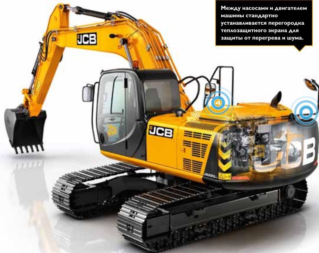
Между насосами и двигателем машины стандартно устанавливается перегородка теплозащитного экрана для защиты от перегрева и шума.
